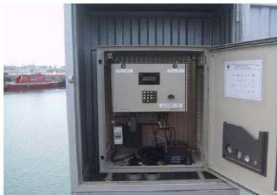
Ce réseau de marégraphes côtiers numériques est dédié à l'observation de la variation du niveau des mers. Le service hydrographique de la DPDPM procède à l'archivage et au traitement des observations de la marée pour déterminer et améliorer les paramètres caractéristiques de la marée de chaque site de mesure.
